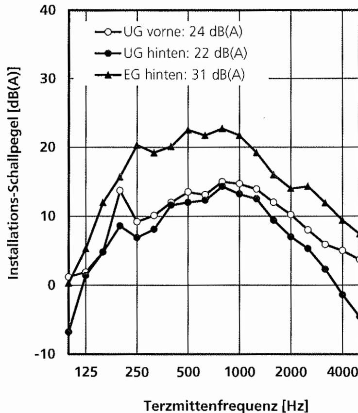
Frequenzverlauf des Installations-Schallpegels bei Geräuschanregung mit dem Körperschall-Geräuschnormal (KGN), gemessen in den Räumen UG vorne, UG hinten und EG hinten. In der Legende sind die Installations-Schallpegel  $L_{A\text{Freq},n}$  ( $L_{in}$ ) in dB(A) nach DIN 4109 für den abgebildeten Frequenzbereich von 100 bis 5000 Hz angegeben.
