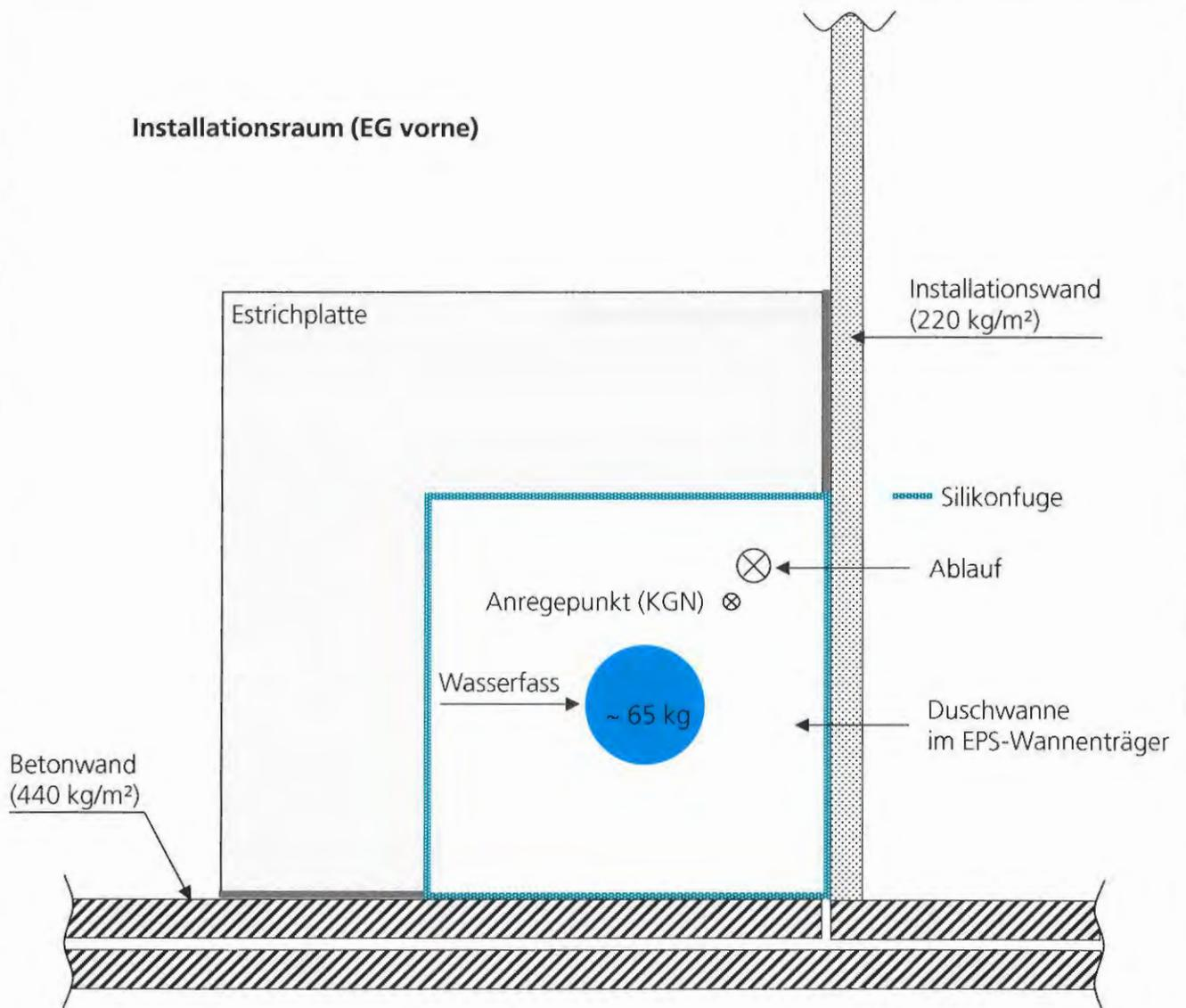
Lage des Prüfaufbaus im Installationsraum (EG vorne).
