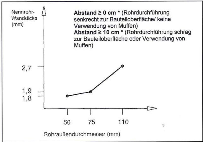
**Rohre gemäß Rohrgruppe D:** (Rohrmanschette "UNIFOX" oder "UNIFOX plus", senkrecht zur Bauteiloberfläche durchgeführte Rohre, keine Isolierung)
