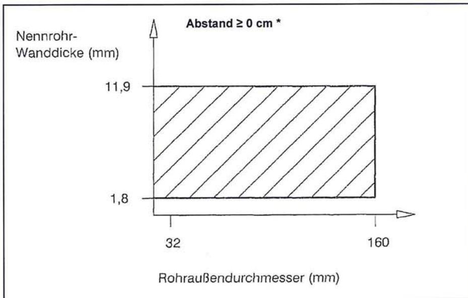
Rohre gemäß Rohrgruppe B-2: (Rohrmanschette "UNIFOX" oder "UNIFOX plus", senkrecht zur Bauteiloberfläche durchgeführte Rohre, keine Isolierung)
