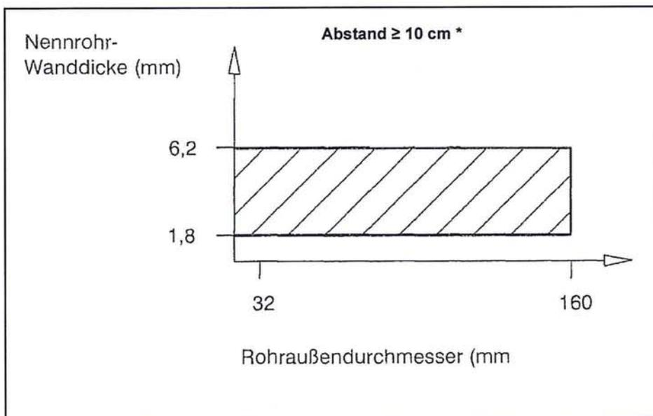
**Rohre gemäß Rohrgruppe B-5:** (Rohrmanschette "UNIFOX" oder "UNIFOX plus", schräg zur Bauteiloberfläche durchgeführte Rohre, Verwendung von Muffen bei Deckeneinbau an senkrechten Rohren, keine Isolierung)
