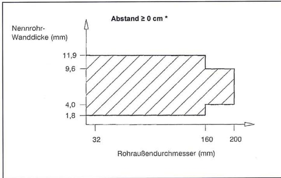
Rohre gemäß Rohrgruppe B-1: (Rohrmanschette "UNIFOX" oder "UNIFOX plus", senkrecht zur Bauteiloberfläche durchgeführte Rohre, keine Isolierung)
