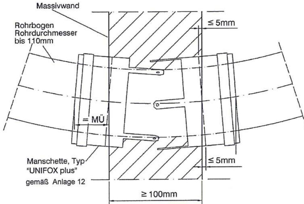
Kabeldurchführung bei Rohrpostanlagen
