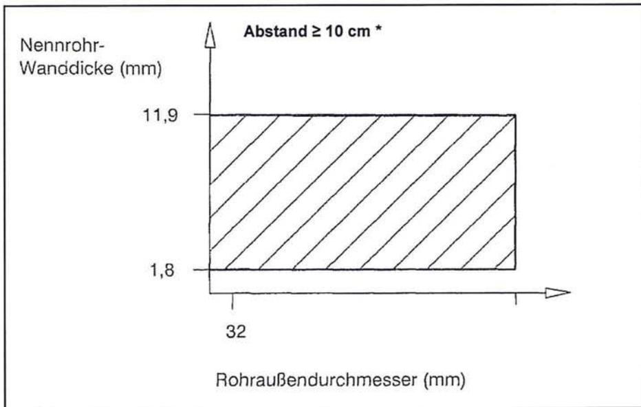
Rohre gemäß Rohrgruppe B-4: (Rohrmanschette "UNIFOX" oder "UNIFOX plus", senkrecht zur Bauteiloberfläche durchgeführte Rohre mit Synthese-Kautschuk-Isolierung gemäß Anlage 2)
