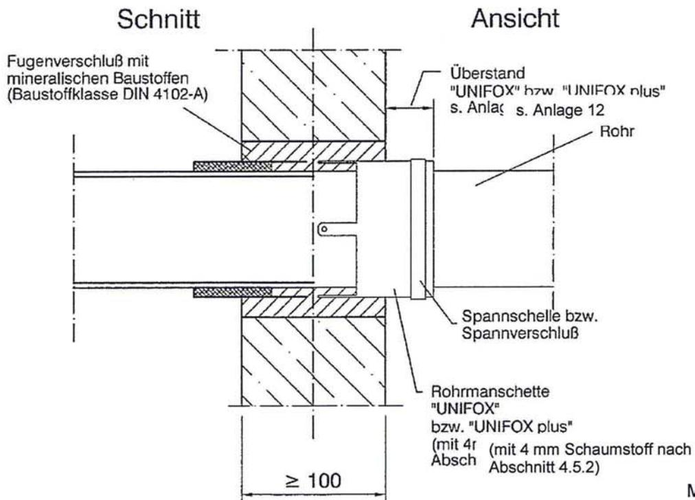
Rohrabschottung "System PYRO-FOX" der Feuerwiderstandsklasse R 90 nach DIN 4102-11
