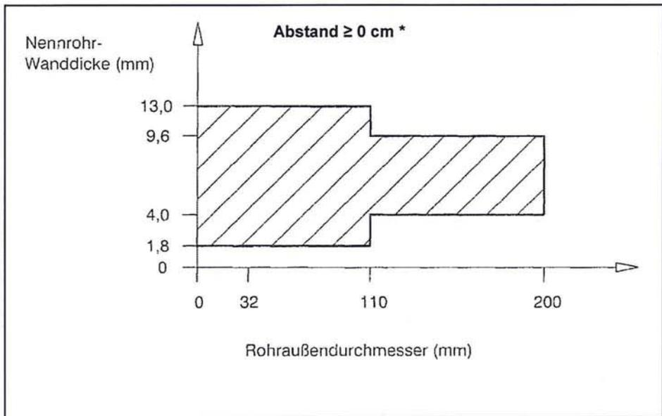
Rohre gemäß Rohrgruppe B-3: (Rohrmanschette "UNIFOX" oder "UNIFOX plus", senkrecht zur Bauteiloberfläche durchgeführte Rohre, keine Isolierung)
