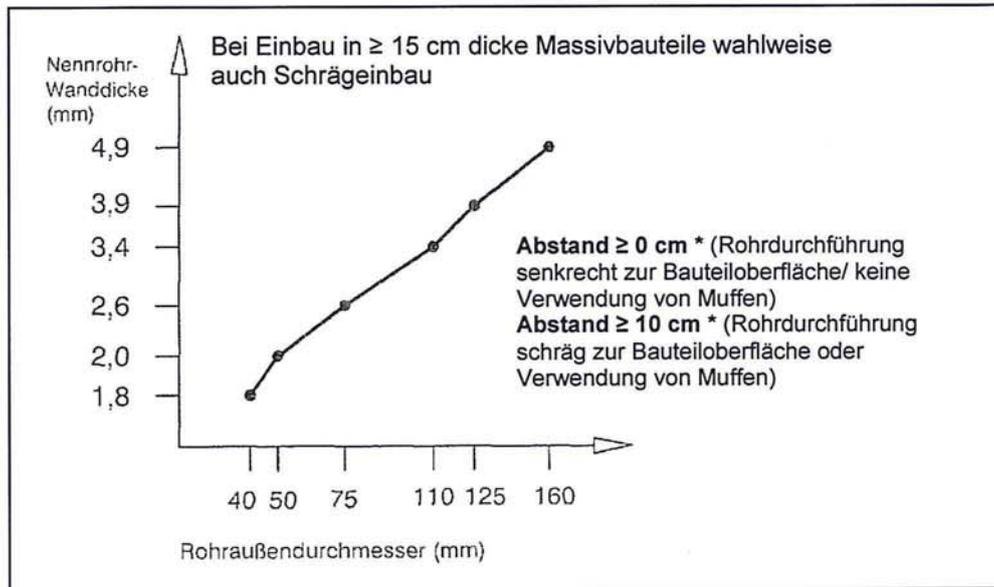
Rohre gemäß Rohrgruppe F: (Rohrmanschette "UNIFOX" oder "UNIFOX plus", wahlweise Verwendung von Muffen bei Deckeneinbau an senkrechten Rohren, keine Isolierung)
