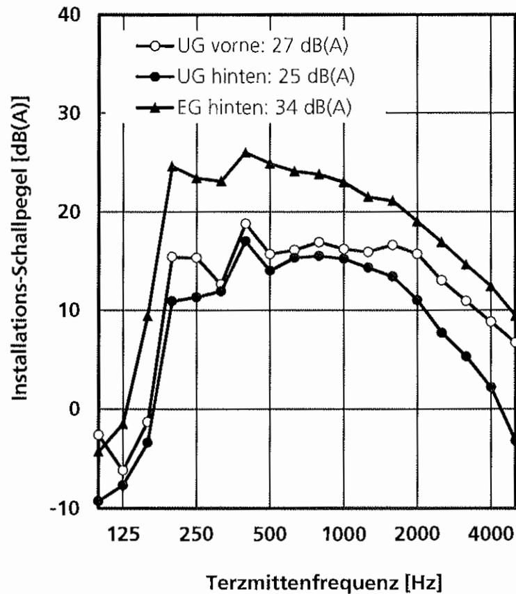
Frequenzverlauf des Installations-Schallpegels bei Geräuschanregung mit dem Körperschall-Geräuschnormal (KGN), gemessen in den Räumen UG vorne, UG hinten und EG hinten. In der Legende sind die Installations-Schallpegel  $L_{A\text{Feg},n}$  ( $L_{in}$ ) in dB(A) nach DIN 4109 für den abgebildeten Frequenzbereich von 100 bis 5000 Hz angegeben.
