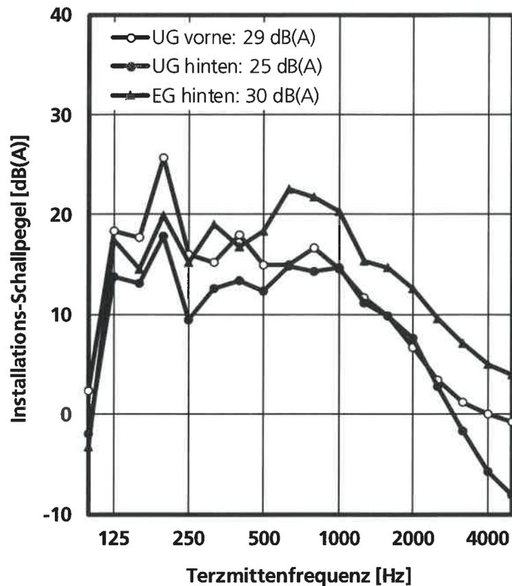
Frequenzverlauf des Installations-Schallpegels bei Geräuschanregung mit dem Körperschall-Geräuschnormal (KGN), gemessen in den Räumen UG vorne, UG hinten und EG hinten. In der Legende sind die Installations-Schallpegel  $L_{AFeq,n}$  in dB(A) nach DIN 4109 für den abgebildeten Frequenzbereich von 100 bis 5000 Hz angegeben.
