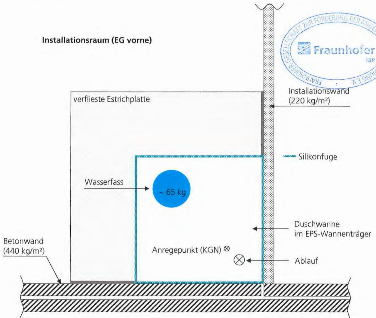
Lage des Prüfaufbaus im Installationsraum (EG vorne).
