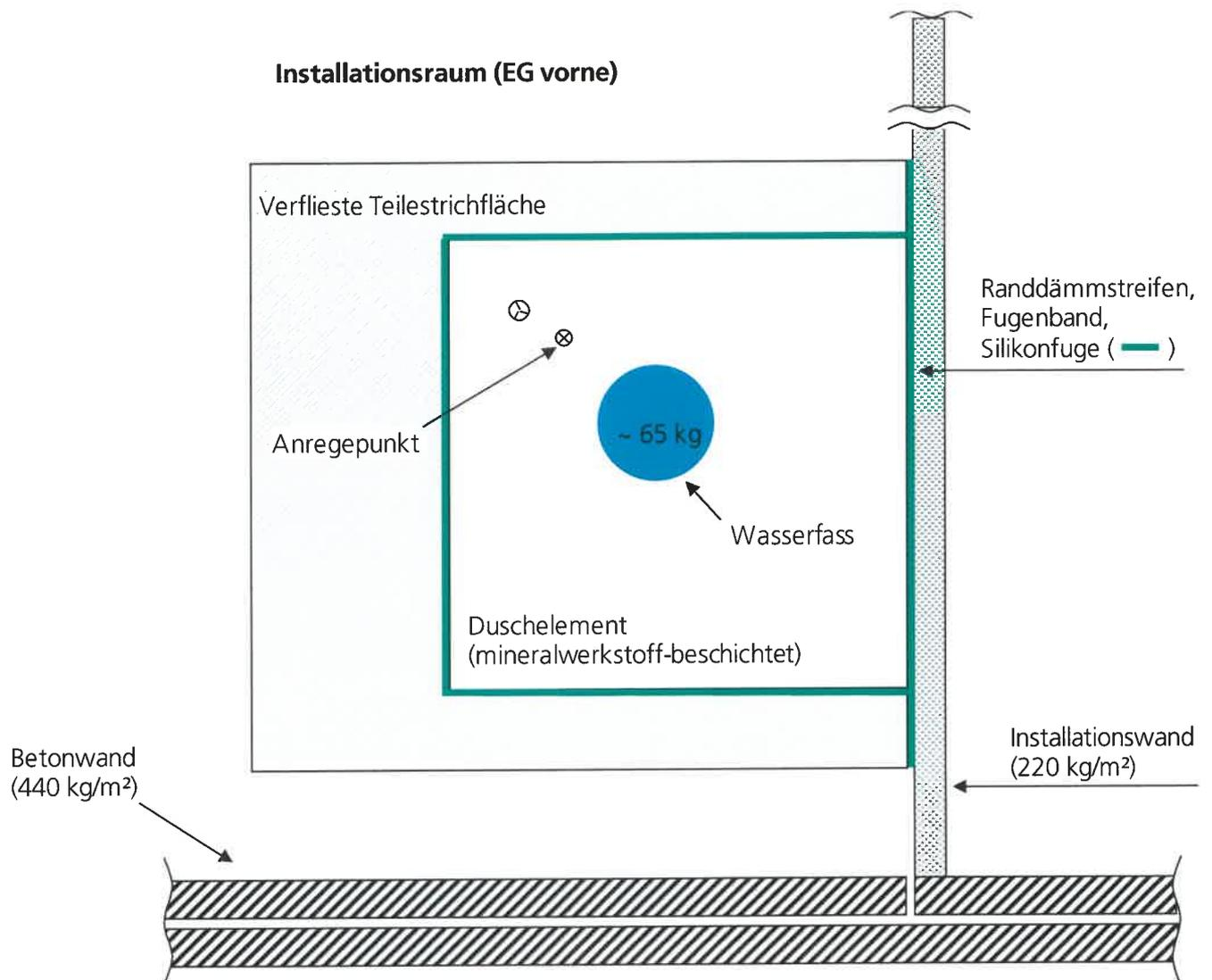
Lage des Prüfaufbaus im Installationsraum (EG vorne).
