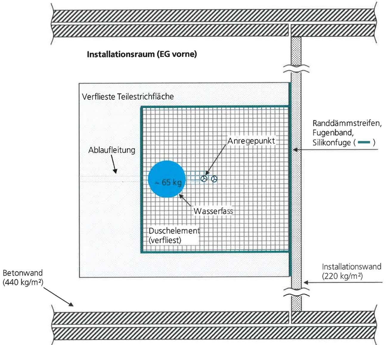
Lage des Prüfaufbaus im Installationsraum (EG vorne).
