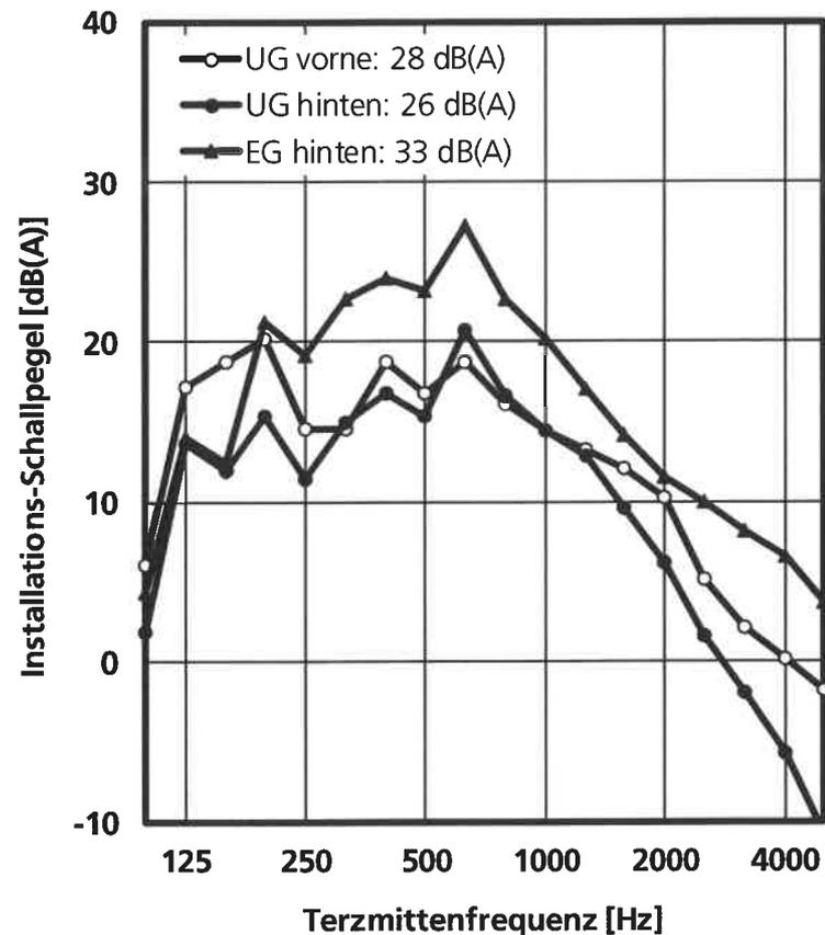
Frequenzverlauf des Installations-Schallpegels bei Geräuschanregung mit dem Körperschall-Geräuschnormal (KGN), gemessen in den Räumen UG vorne, UG hinten und EG hinten. In der Legende sind die Installations-Schallpegel  $L_{A\text{Feq},n}$  in dB(A) nach DIN 4109 für den abgebildeten Frequenzbereich von 100 bis 5000 Hz angegeben.
